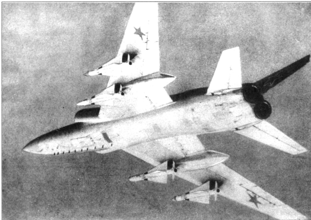
Ракеты Р-4 на тяжелом перехватчике Ту-128
