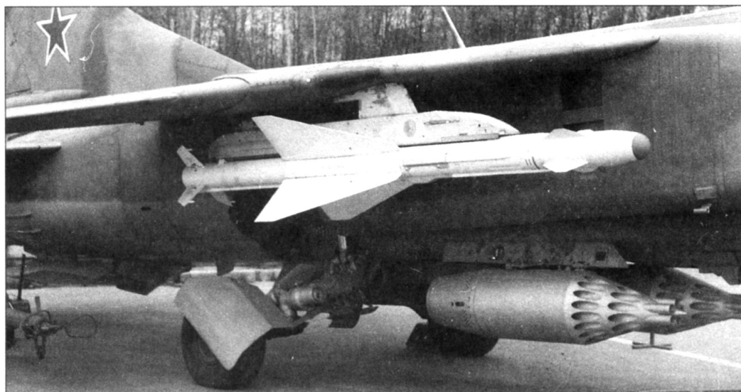
Р-23Т на пусковом устройстве АПУ-23М1 истребителя МиГ-23МЛ
