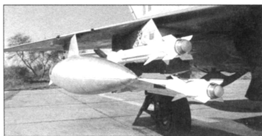
Подвеска Р-60М на спаренной пусковой АПУ-60-II самолета МиГ-21бис индийских ВВС
