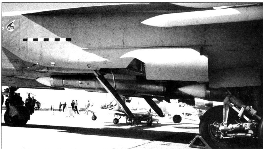
Р-37 на подфюзеляжной подвеске истребителя МиГ-31М
