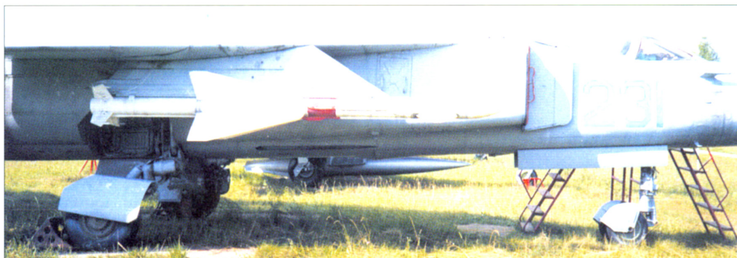
Опытный истребитель МиГ-23 с ракетами Р-23Р
