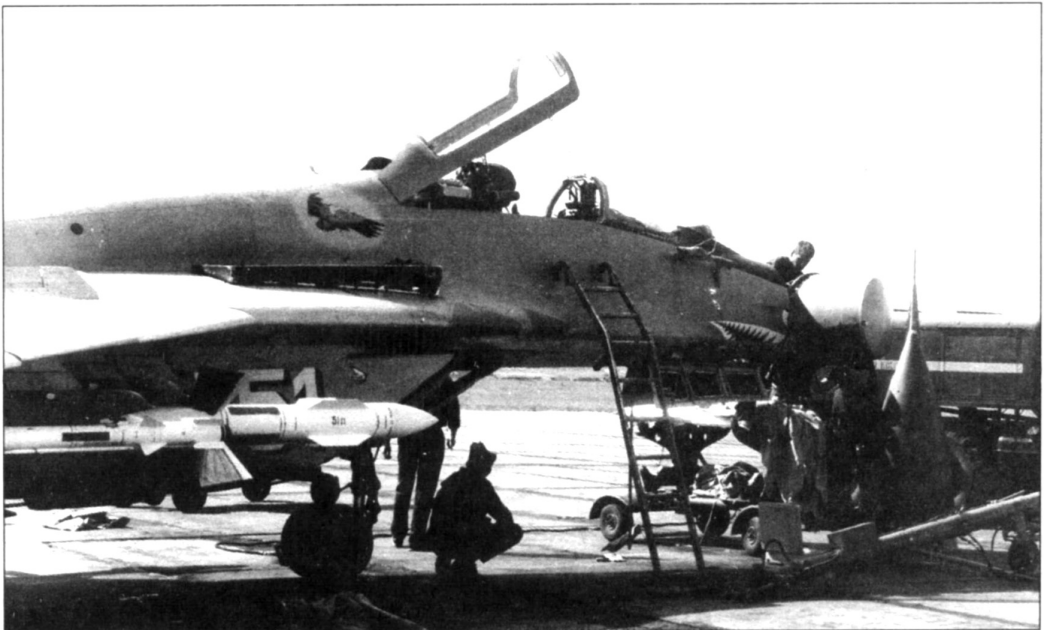
Ракеты с подстроеными по частотам определенному радиолокатору ГСН несут маркировку «своего» самолета
