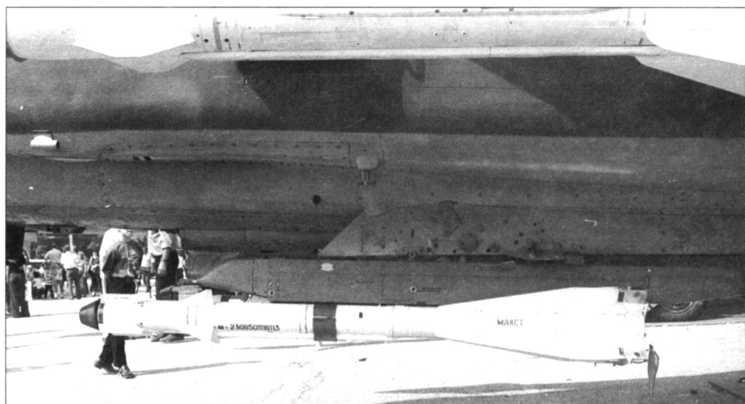
Макетная Р-60 на АПУ-60-I под фюзеляжем истребителя МиГ-23М
