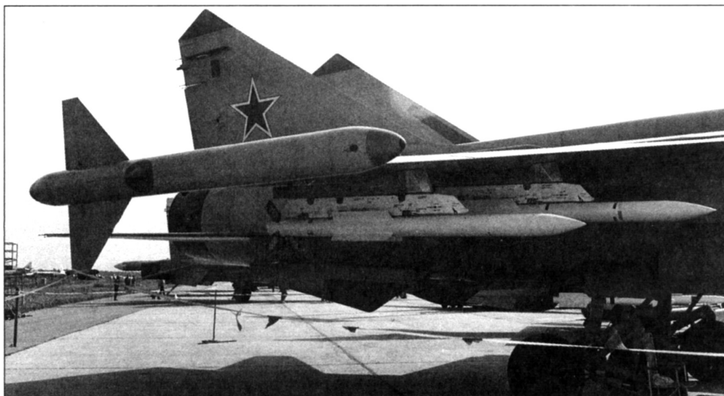
Р-77 в составе вооружения перехватчика МиГ-31М
