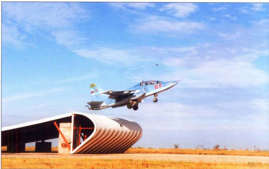
Взлет с трамплина в испытательном центре "НИУТК" в Крыму самолета Су-25УТГ бортовой номер "64". (Павел Маслов)
