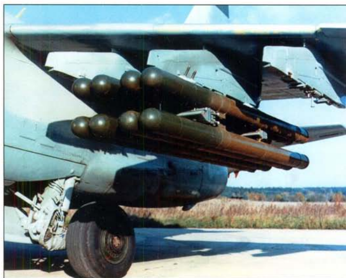
Ракета "Вихрь-М" и пусковой контейнер". (Конструкторское бюро приборостроения)
