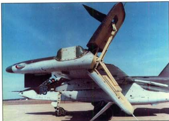
Тормозные щитки в раскрытом виде. Самолет Т8-15. (АООТ "ОКБ Сухого")
