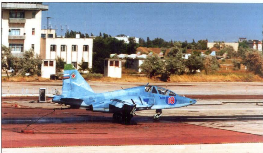
Зацепление за гак при посадке на аэродроме комплекса «НИУТГ». (Павел Маслов)
