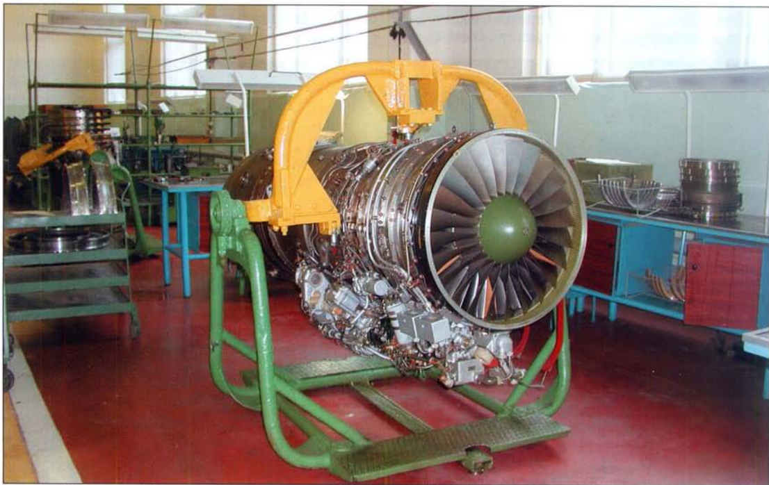
Ремонт двигателя P95Ш. (218 АРЗ)
