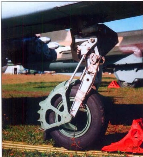
Пневматик колеса передней стойки шасси с защитным кожухом. (Ильдар Бедретдинов)
