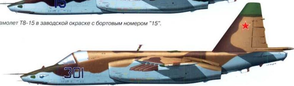
Опытный самолет Т8-15 в новой окраске с бортовым номером "301" с дополнительными ПВД подготовленными для перелета на авиашоу в Ле Бурже. На самолете установлены двигатели Р195.
