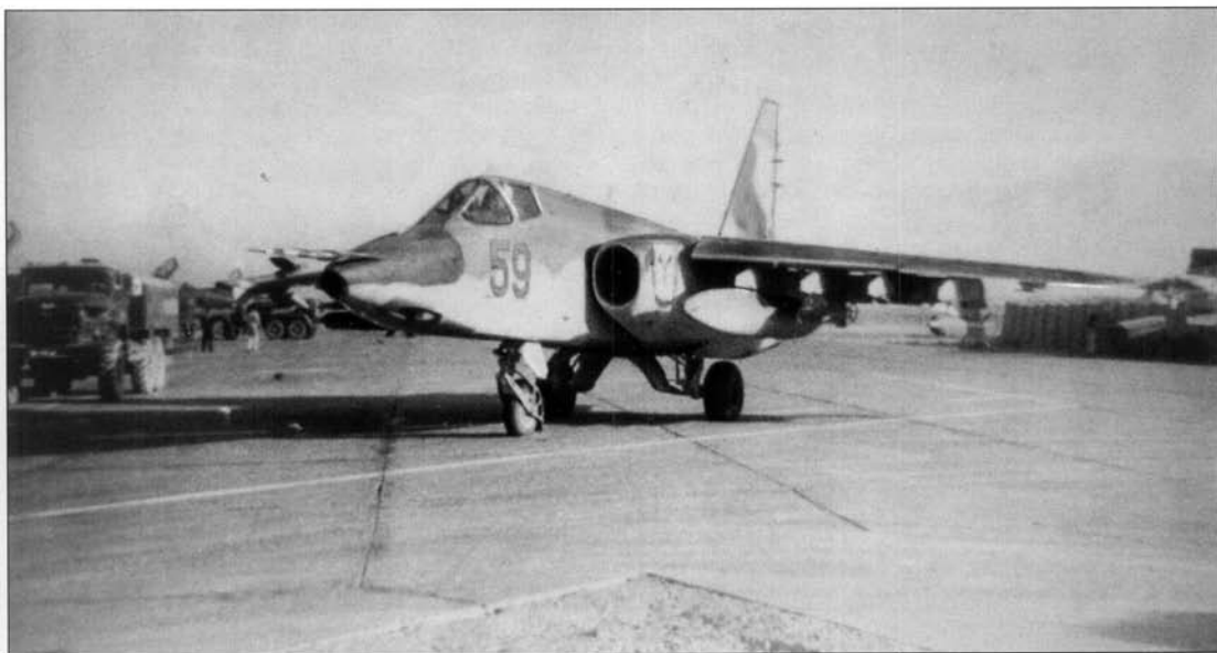
Самолет Су-25 (бортовой номер "59") приземлился после выполнения боевого задания и заруливает на стоянку. Видны подвешенные топливные баки ПТБ-800. Аэродром Кандагар. (Валерий Максименко)
