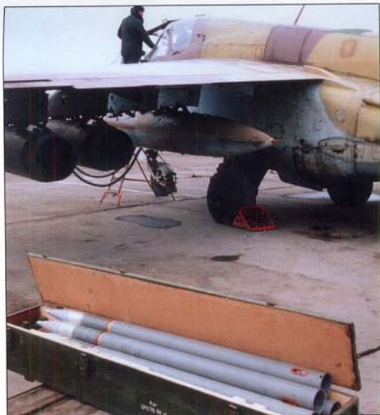
Подготовка к снаряжению блоков Б-8М НАР С-8. Под крылом штурмовика видны подвешенные баки ПТБ-800 и два блока Б-8М. (Сергей Балаклеев)
