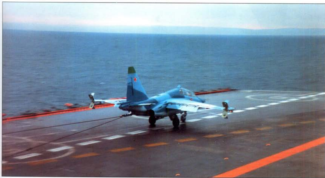
Момент зацепления гака самолета за трос аэрофинишера. (Сергей Скрынников)
