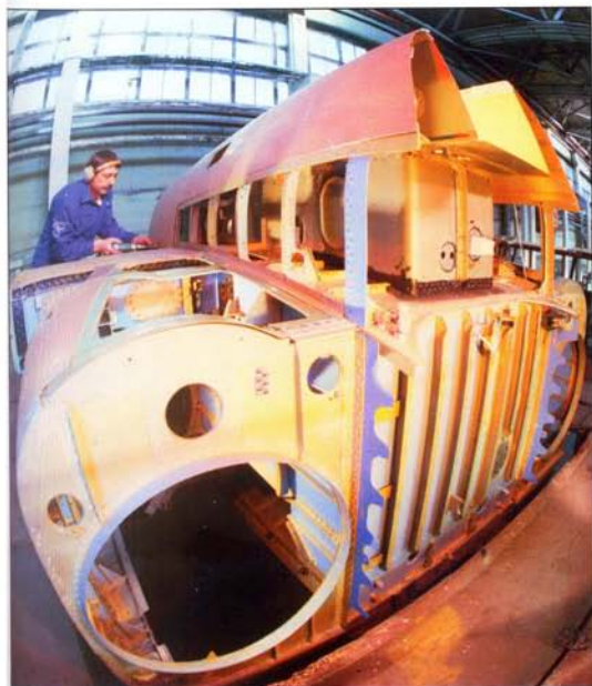
Сборка средней части фюзеляжа в цехах Улан-Удэнского авиазавода. (Улан-Удэнский авиазавод)
