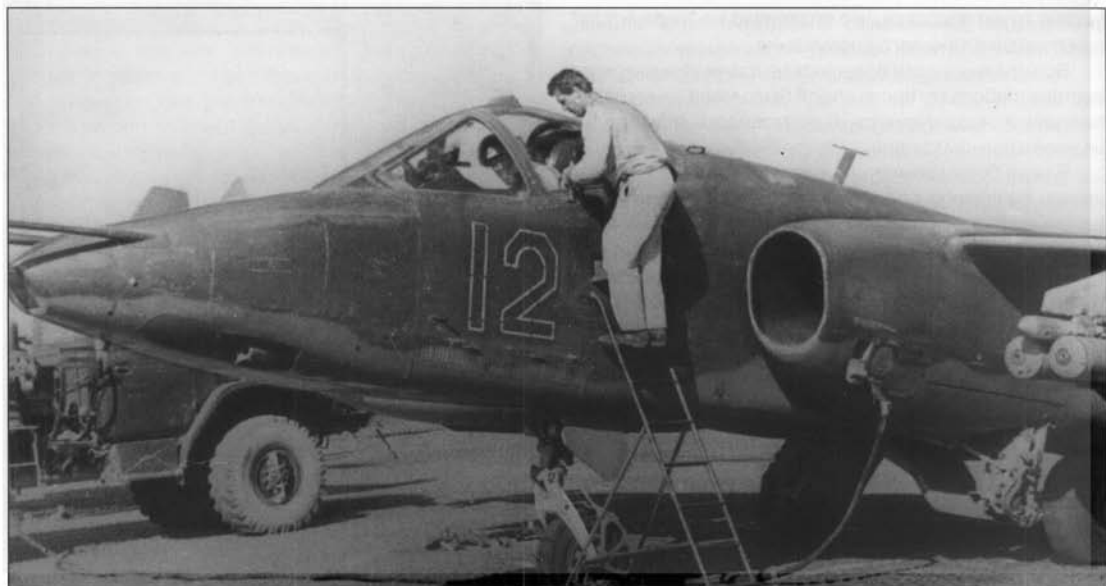
Подготовка самолета к боевому вылету (бортовой номер "12"). На фотографии – машина ранней серии. Под пилоном видна подвеска 100 кг бомб на многозвонковом балочном держателе МБД2-67У. (Николай Надворецкий)
