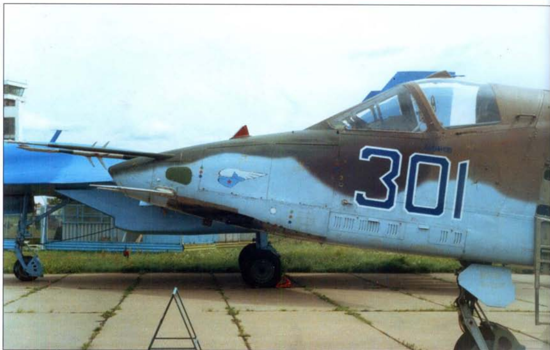
Носовая часть самолета Т8-15 (бортовой номер 301). Снизу видна 30-мм пушка. (Ильдар Бедретдинов)
