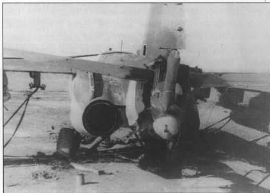
Самолет летчика П. Голубцова, пораженный ПЗРК "Stinger".
