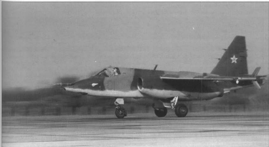
Момент посадки Т8-1Д. На законцовках крыльев уже установлены гондолы тормозных щитков (односекционные). (АООТ "ОКБ Сухого")
