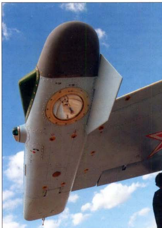
Антенны станции СПО-15 в передней части тормозных гондол, справа противобликовый щиток. (Алексей Михеев)
