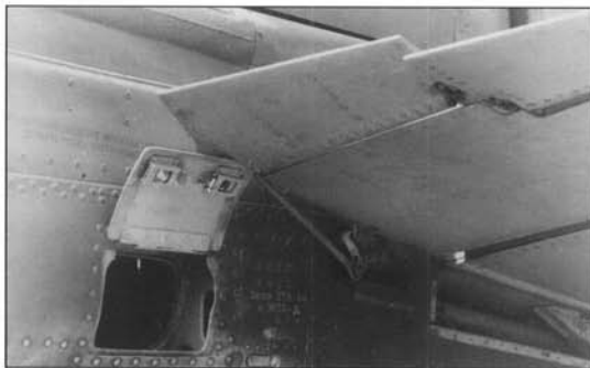
Заклинивание узла навески сервокомпенсатора руля высоты крышкой люка подхода тормозного парашюта (фрагмент эксперимента по определению причины летного происшествия самолета). (Гос НИИ ЭРАТ)
