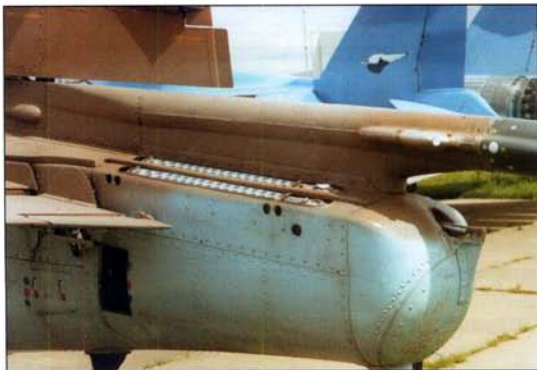
Автомат постановки помех АСО-2В в хвостовой части штурмовика. (Ильдар Бедретдинов)
