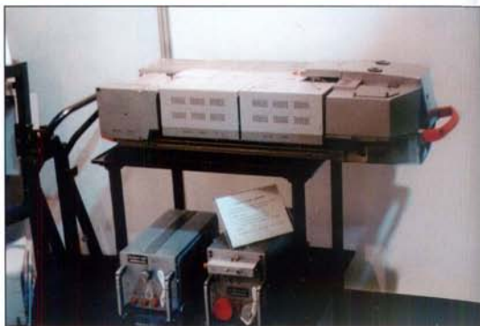
Лазерная станция "Клен-ПС". (Ильдар Бедретдинов) Сверху на фотографии: лазерный дальномер-подсветчик. Снизу, слева направо: гиросtabilизирующий привод и блок целеуказания управляемым ракетам.
