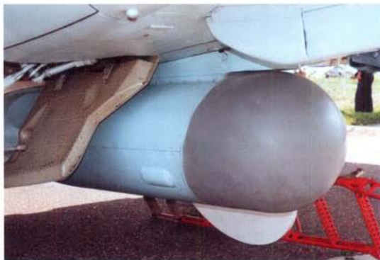
РЛС "Копье" в подвесном контейнере под фюзеляжем самолета Су-39. (Ильдар Бедретдинов)
