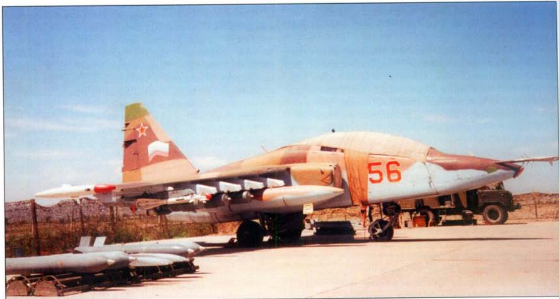
Су-25УБ с бортовым номером 56. Аэродром Душанбе. На переднем плане слева подготовленные к подвеске НАР С-24. Под крылом штурмовика подвешены: топливный бак ПТБ-800, бомбы ФАБ-250М54 и управляемая ракета "воздух-воздух" Р-73. (Виктор Бельцов)
