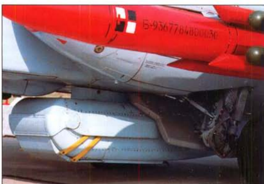
Самолет Су-25Т с бортовым номером «10». Под фюзеляжем на шестой точке подвески подвешен тепловизионный контейнер. (Сергей Скрынников)
