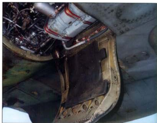
Бронеплита защиты масляного бака правого двигателя. (АООТ "ОКБ Сухого")
