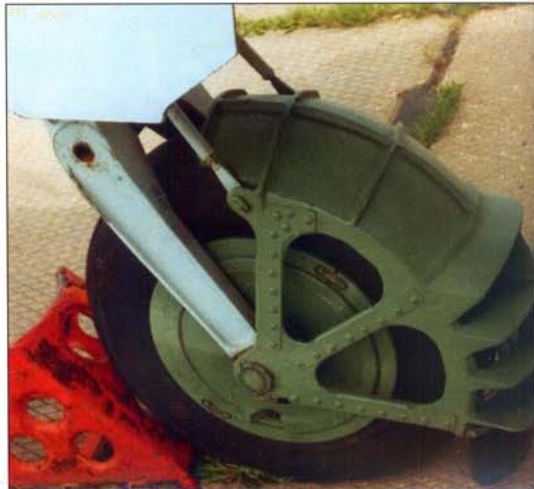
Пневматик колеса передней стойки шасси с защитным кожухом. (Ильдар Бедретдинов)
