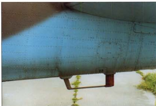
Антенна маркерного радиоприемника МРП-56 (слева вверху) в виде зеленого клина. (Сергей Балаклеев)
