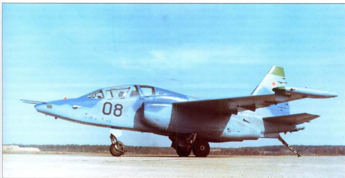
Самолет Су-25УТГ-1 (бортовой номер «08») на аэродроме испытательного центра Саки. Вид 3/4 спереди. Гак опущен. (АООТ «ОКБ Сухого»)
