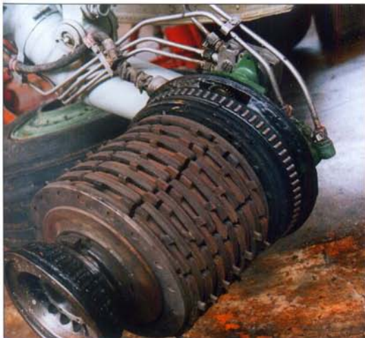
Тормозная система колеса основной стойки шасси. (Сергей Балаклеев)
