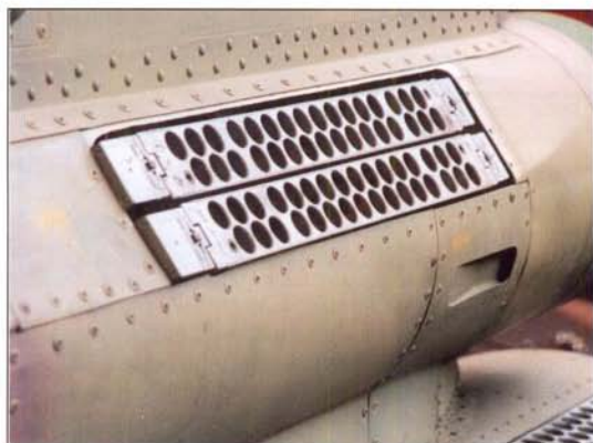
Слева-сверху: станция ИК-помех «Сухогруз» на самолете Су-25Т (Т8М-3). (АООТ «ОКБ Сухого»)
