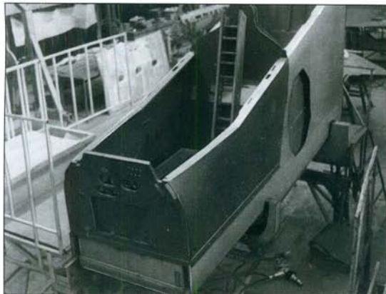
Фотография сварной кабины из титановой брони самолета Су-25УБ. (АООТ "ОКБ Сухого")
