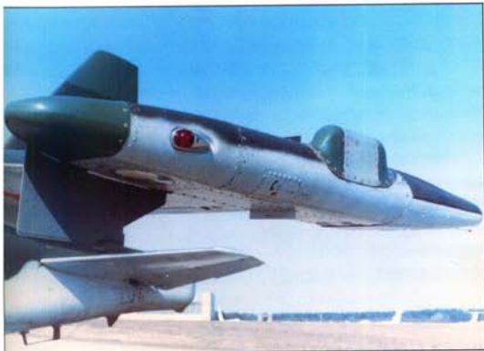
Тормозные щитки в закрытом виде. Самолет Т8-15. (АООТ "ОКБ Сухого")
