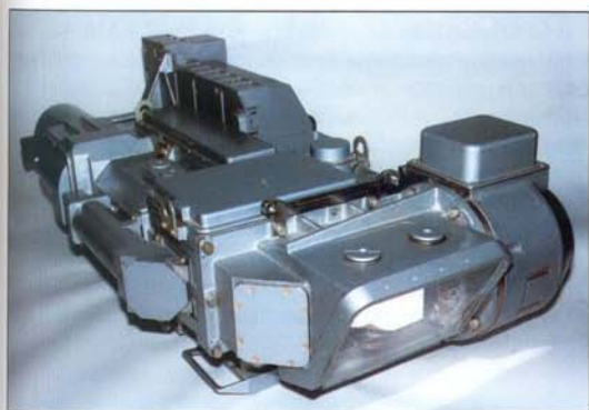
Дневной прибор управления системы «Шквал». (Красногорский оптико-механический завод)
